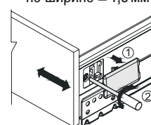
Регулировка по ширине ± 1,5 мм
