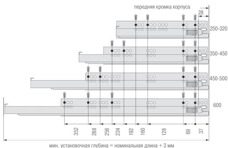
Размеры для установки направляющих полного выдвижения
