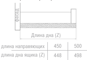
Размеры для раскроя дна ящика
